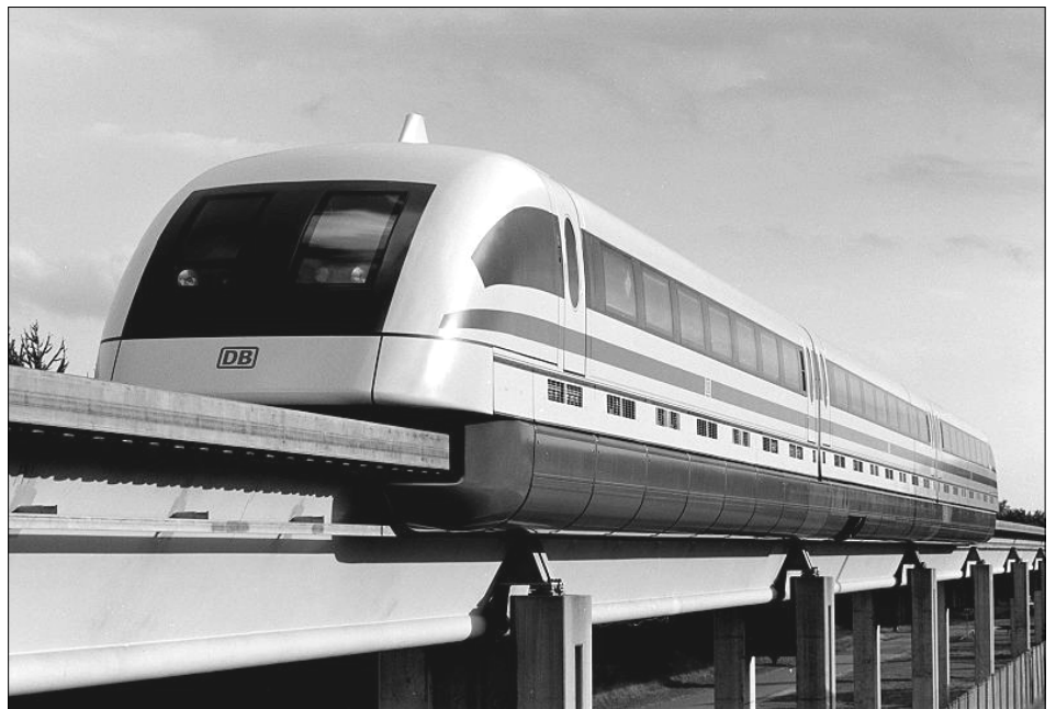
Vorserienfahrzeug Transrapid 08 in der Versuchsanlage Emsland
